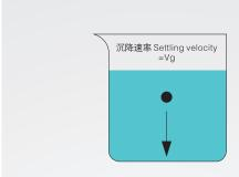
重力分离 Gravity separation 驱动力 Driving force 1g
