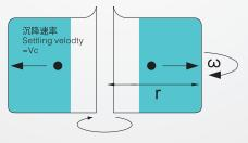
离心分离 Centrifugal separation 驱动力 Driving force rw<sup>2</sup>
